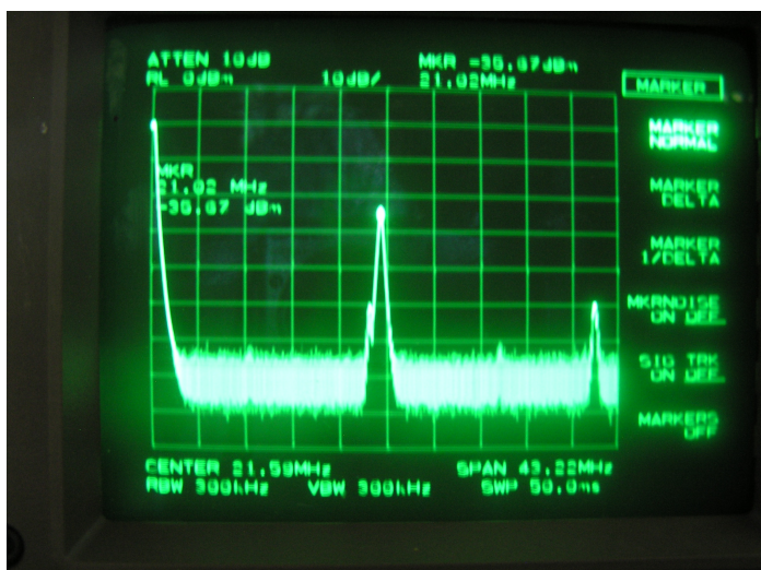
21MHz. Het sperfilter op 20MHz hakt er nu goed in. Nauwelijks 27dB tussen MF en carrier, en LO en carrier.
